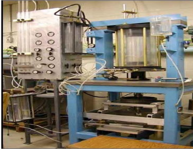
Foto 8. Equipo de ensayo de corte torsional cíclico. Curso de Dinámica de Suelos, Denys Parra Murrugarra
