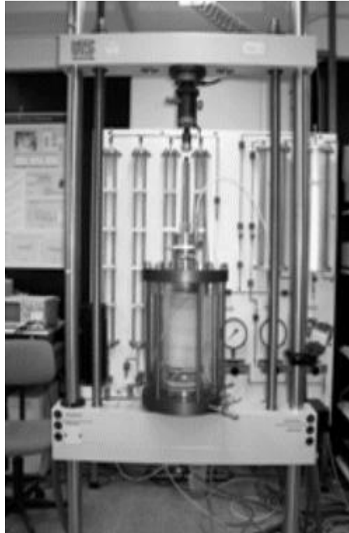
Foto 5. Equipo Triaxial Cíclico , el equipo pertenece al laboratorio de dinámica de suelos de la Ruhr Universidad de la ciudad de Bochum en Alemania. Estimación de la Historia De Precarga Cíclica de un Suelo, con ayuda del potencial de licuación, Luis Collarte Concha, Mauro Esteban Poblete Freire.
