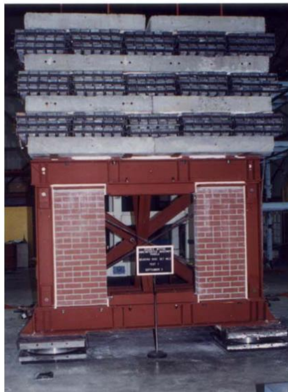
Figura 27. La estructura aislada permanece intacta después de 58 sismos incluyendo cargas sísmicas de magnitud 8 (Earthquake Protection Systems, 2005).
