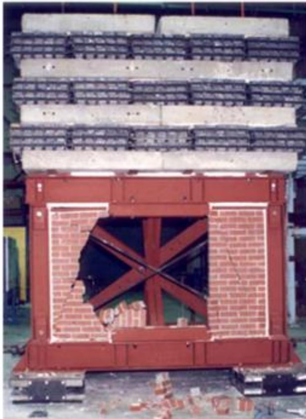
Figura 28. La estructura no aislada falla después de 3 sismos de magnitudes 5, 6 y 7, respectivamente (Earthquake Protection Systems, 2005).
