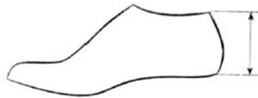
**Volumen en los flancos del talón:** Se refiere a la forma curvada que adoptan los flancos interior y exterior de la zona del talón. Esta forma de los laterales permite proporcionar la compresión necesaria para una buena sujeción del pie.
