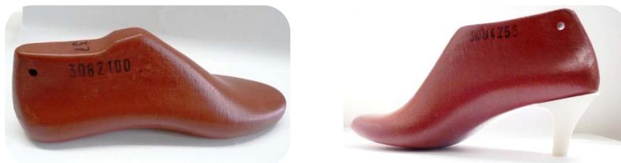
**4.3.2. Diseño, modelado y fabricación de calzado.** Para el diseño del calzado se optó por un diseño sencillo de acuerdo al estilo urbano y al modelo más común utilizado por las mujeres. El modelado de los patrones de corte se realizó a través del software Rhinoceros 4.0. En la Figura 75 se pueden apreciar a manera de referencia. Los resultados de la fabricación se pueden apreciar en la Figura 76, este calzado fue elaborado en una empresa de la industria local, con materiales sintéticos.
