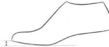
**Espesor de la puntera:** Espesor tomado desde el plano inferior de la horma hasta el nivel del extremo anterior del pie sobre la horma. Esta altura no puede ser nunca inferior a la altura del dedo más alto, pues el roce de los dedos con el material del zapato puede ocasionar problemas. (Figura 48)
