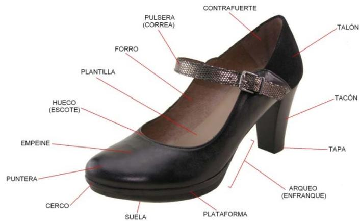
Figura 56. Pictograma partes del calzado<sup>101</sup>
