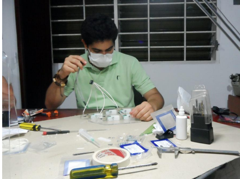
Figura 46. Instalación de Pulsadores
