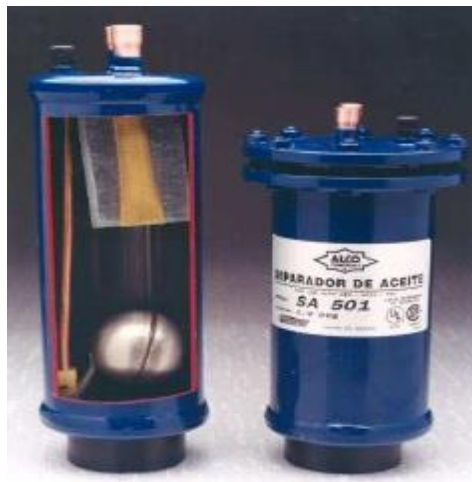
Figura 16. Separador de aceite, tipo sellado y atornillado
