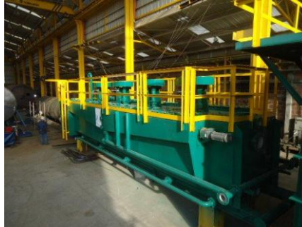
Figura 6. Celda de flotación
