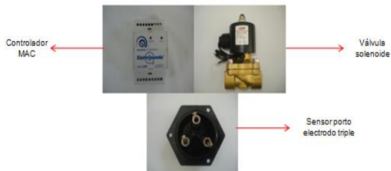
Figura C-1.3. Elementos del lazo de control de nivel.
