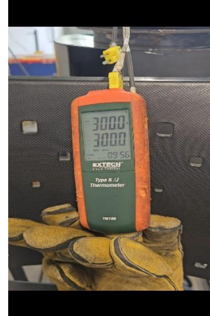
Figura 54. Prueba de calentamiento en vacío del reactor #1
