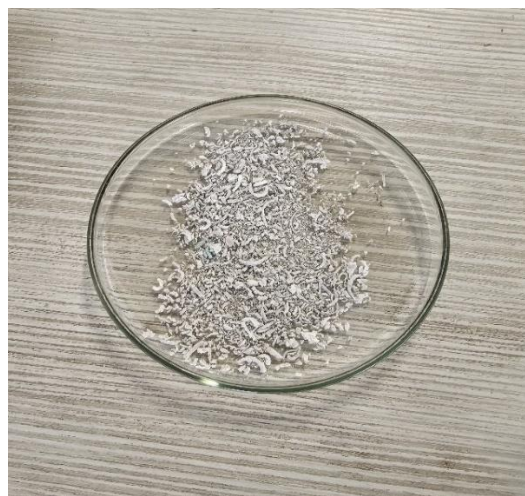
Figura 4. Recolección de cenizas de los crisoles después de la prueba
