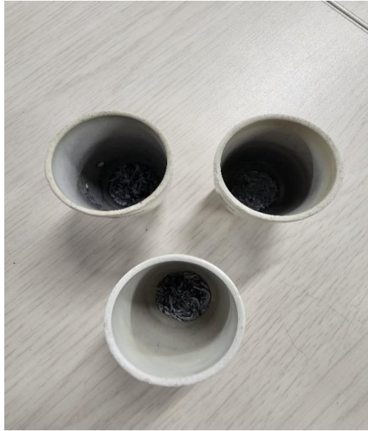
Figura 3. Muestras en crisoles después de prueba de material volátil.
