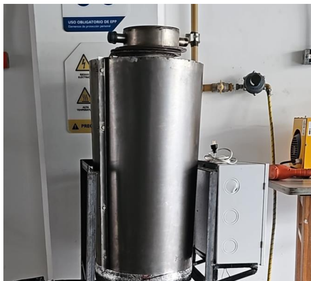
Figura 56. Implementación del sistema de aislamiento
