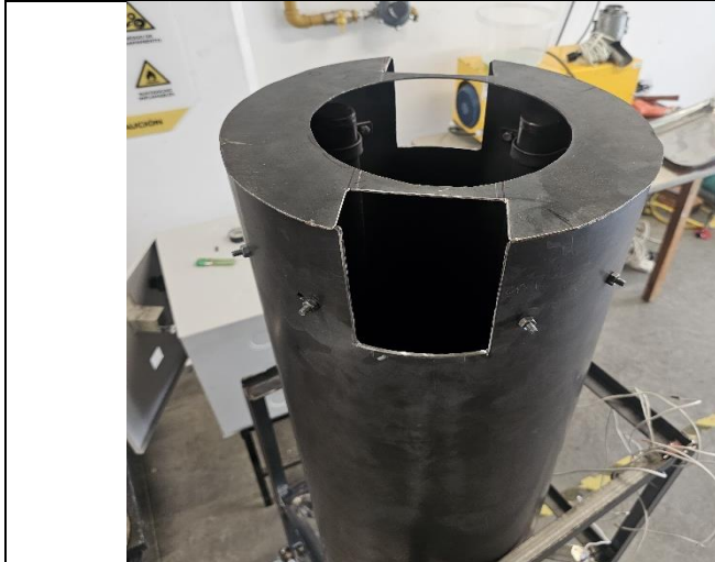
Figura 46. Primera configuración para la salida de los gases de combustión.
