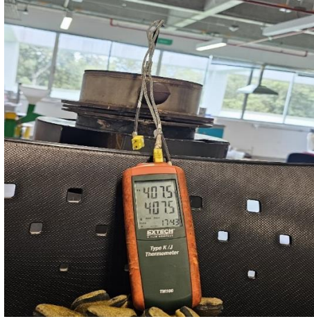
Figura 53. Prueba de calentamiento en vacío del reactor #2
