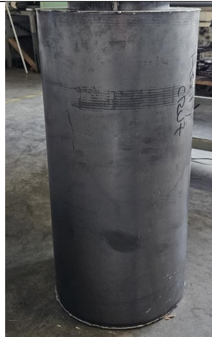
Figura 43. Camisa externa del reactor de acero al carbono HR.
