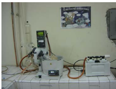
FIGURA 2. Montaje del Rotoevaporador
