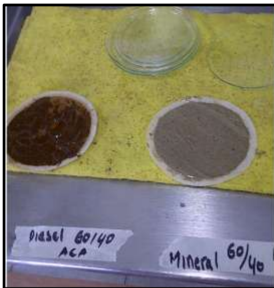
Retorta aceite diesel y aceite mineral
