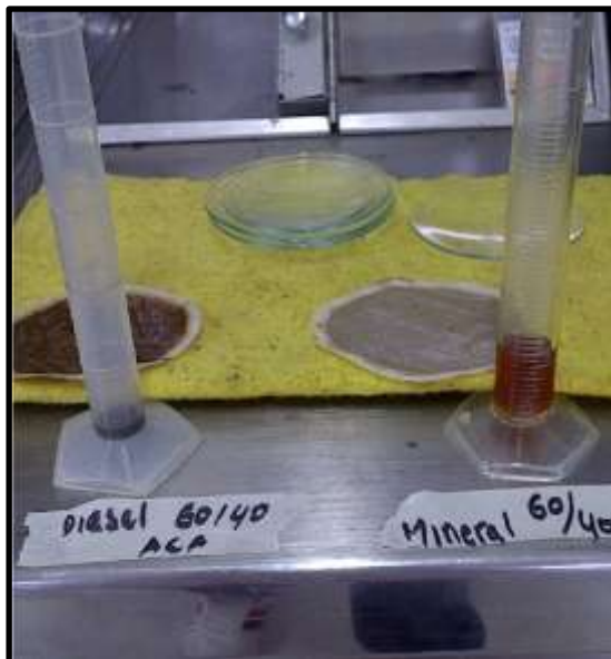
Filtrado API diesel y aceite mineral
