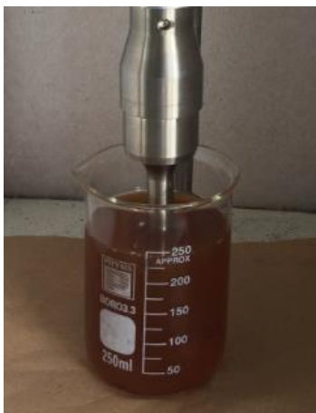
Figura 18. Aplicación de ultrasonido durante la conversión de óxido de grafito en GO
