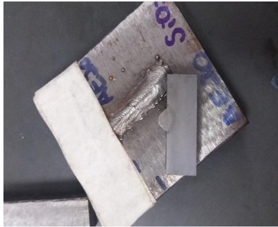
Figura 2. Sección transversal del cordón de soldadura fabricado con A-GMAW y aplicación de SiO 2
