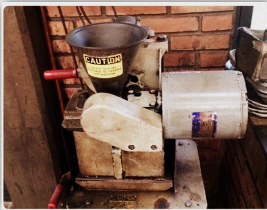
Figura B3. TRITURADOR MALLA 60 (Pulverizador Holmes 500 DG)
