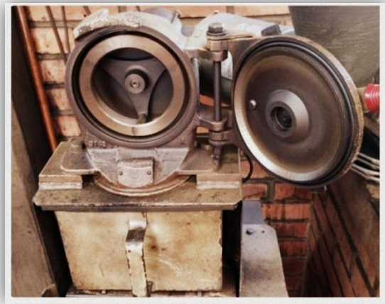
Figura B3. TRITURADOR MALLA 60 (Pulverizador Holmes 500 DG)
