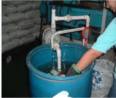
Figura No 8. Enfriamiento de la plantilla
