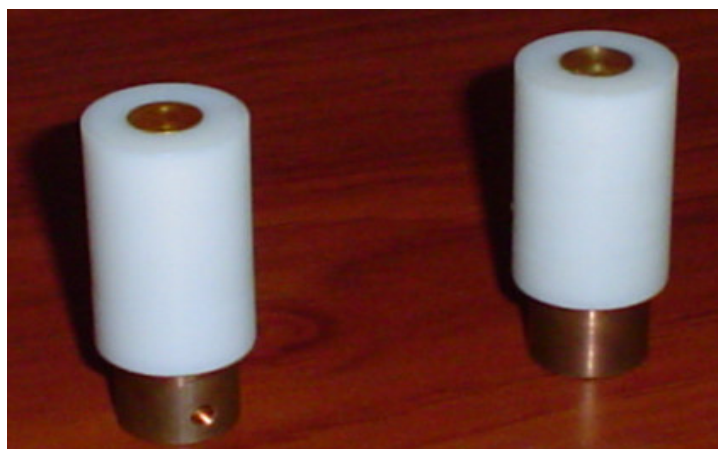
Figura 24. Electrodos de oro de 24 kilates y oro de 18 kilates utilizados en este estudio.
