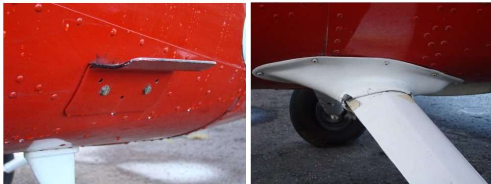
Figura 28. Peldaño para acceso a la cabina y soporte del tren principal
