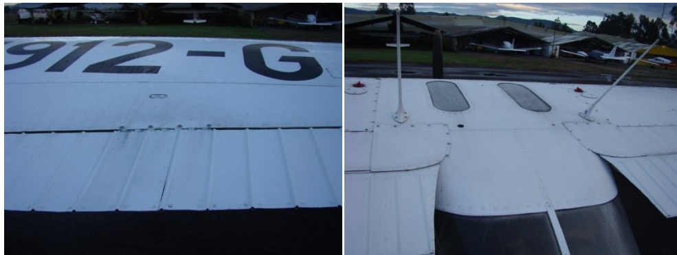
Figura 26. Visagras de giro de los flaps y uniones de flaps a los planos
