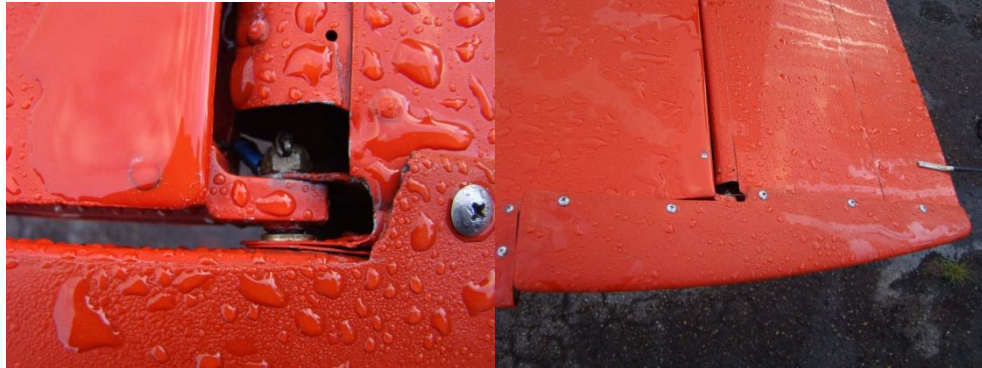
Figura 27. Visagras de giro del estabilizador horizontal
