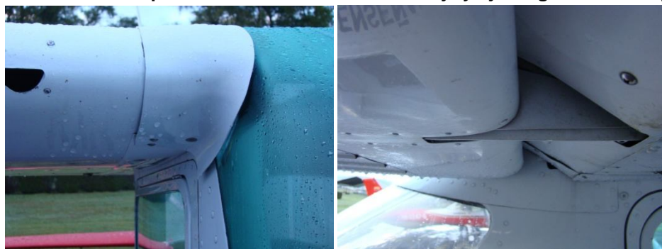
Figura 23. Uniones de los planos de sustentación al fuselaje y eje de giro de los flaps
