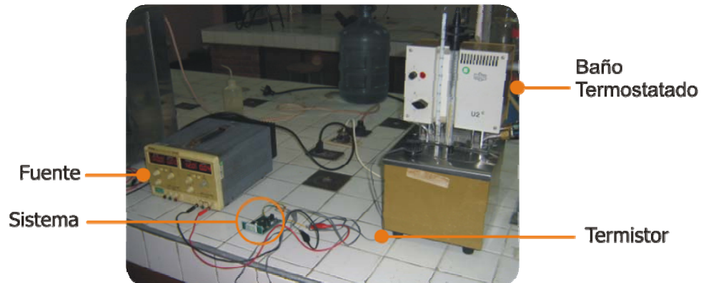
Figura 45: Comparación del sistema con un patrón de medida
