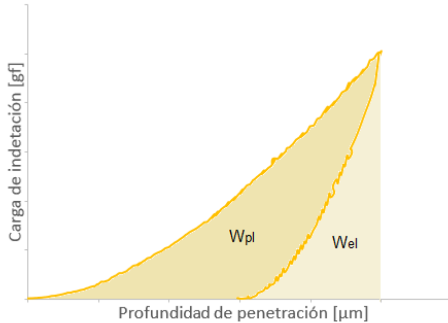
Figura 1. Diagrama esquemático de la curva de carga y descarga obtenida mediante indentación con registro de carga y desplazamiento.
