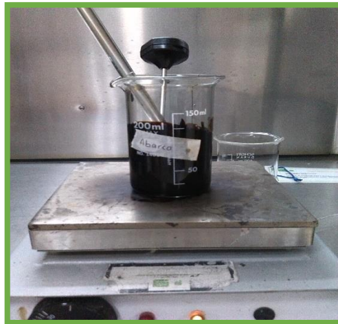
Figura 6. Calentamiento de muestras de crudo.
