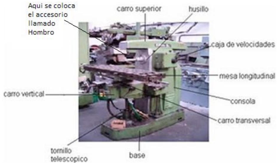
Figura 18. Vista Lateral Derecha. Fresa Para Planear
