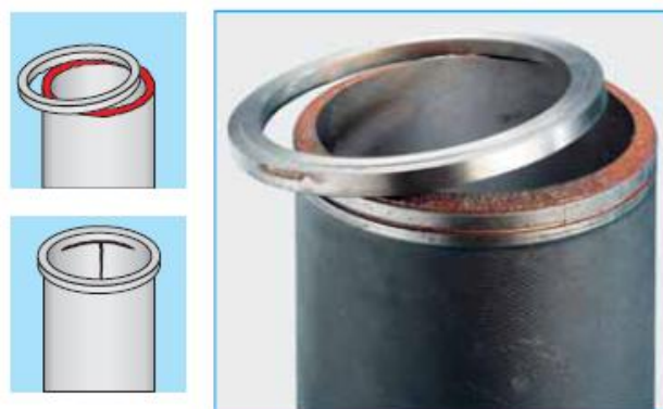
Figura 2. Rotura de collarines de camisa
