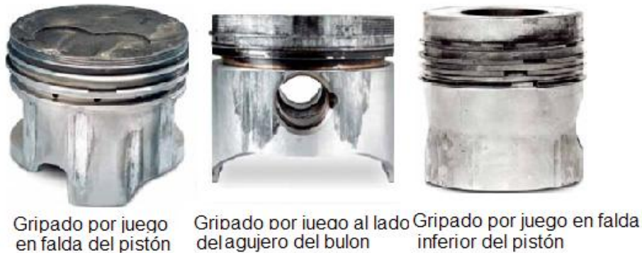
Figura 11. Falla de pistones gripado por juego
