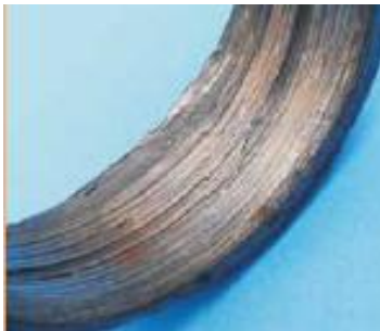
Figura 24. Cojinete con desgaste adhesivo
