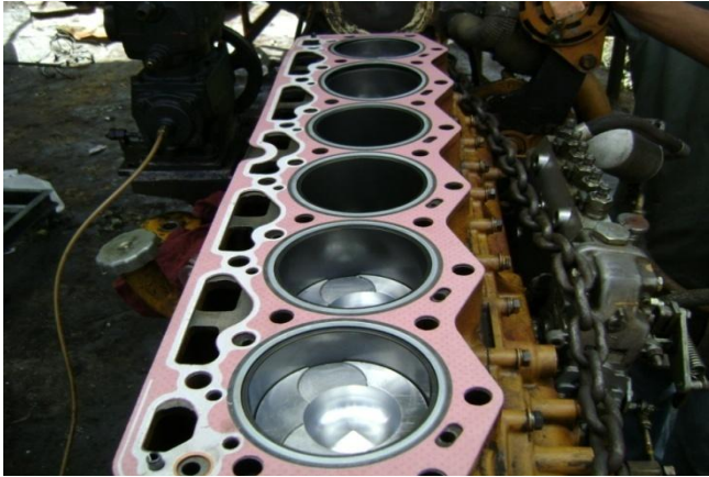
Figura 19. Bloque motor de combustión interna en línea
