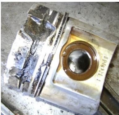
Figura 14. Rotura de pared del pistón
