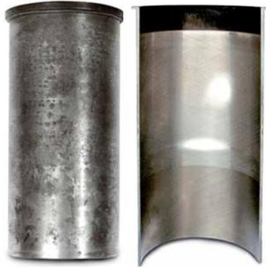
Figura 3. Desgaste irregular del cilindro
