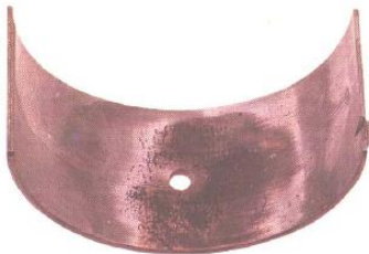
Figura 25. Falla de corrosión en cojinetes
