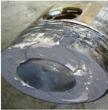
Figura 13. Falla pistón por recalentamiento
