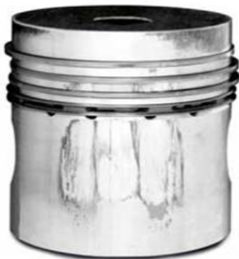
Figura 12. Gripado en falda de pistón
