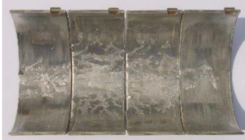
Figura 26. Levantamiento de material en cojinete
