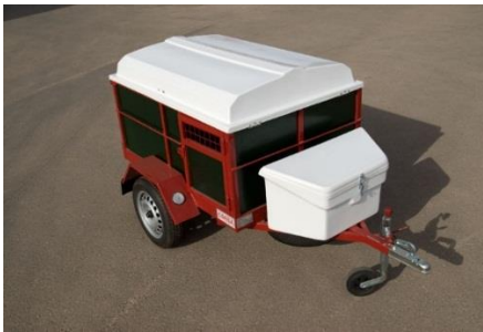
Figura 18. Modelo de carrocería tipo remolque para transporte de animales con sistema isotérmico de ventilación superior. Adaptado de: http://www.remolquescofisa.es/wp-content/gallery/animales-perros/animales1.jpg
