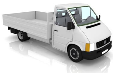
Figura 15. Modelo renderizado por el autor para el chasis tipo minitruck utilizado para la adaptación de una carrocería tipo unidad móvil veterinaria
