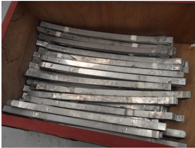
Figura 16. Super bandas para ajustar cable de potencia a la tubería de producción
