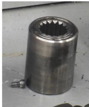
Figura 19. Coupling para engranar eje del motor con el sello
