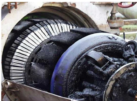
Figura 48. Tecnología ILI "MFL inspection PIG". (Hopkins, 2005).
