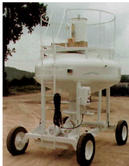
Figura 98. Tanque Probador. (Juan Carlos Mello, Daniel & Emerson, 2005).
