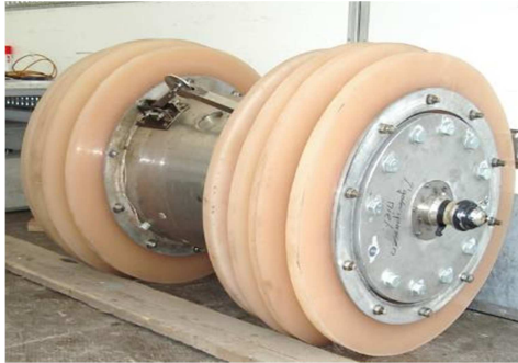
Figura 46. Tecnología ILI tipo "Tethered UT". (Hopkins, 2005).
