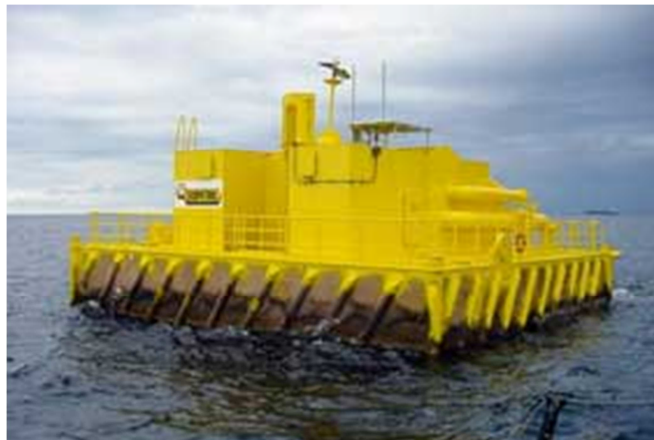
Figura 39. Unidad de cargue de buque tanques TLU 3. (Ecopetrol, 2010).
