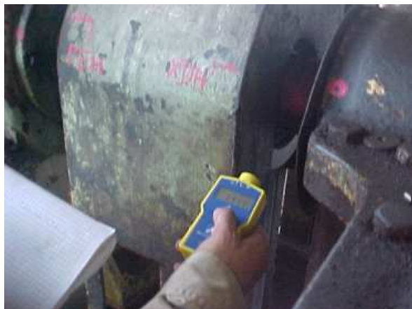
Figura 27. Tacómetro digital para la medición de la velocidad de rotación de la turbina
