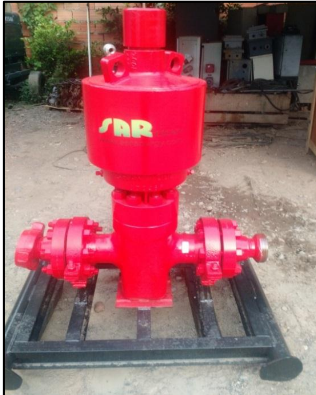
Figura 19. Válvula de emergencia shut down
