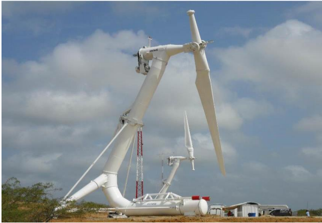
a) Aerogenerador monopala, instalado en el parque de poligeneración, Nazareth, La Guajira
