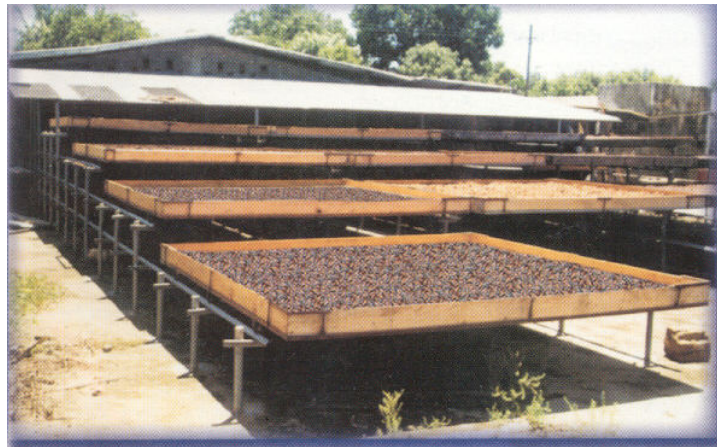
Figura 16. Secador tipo elba, con carros corredizos.
