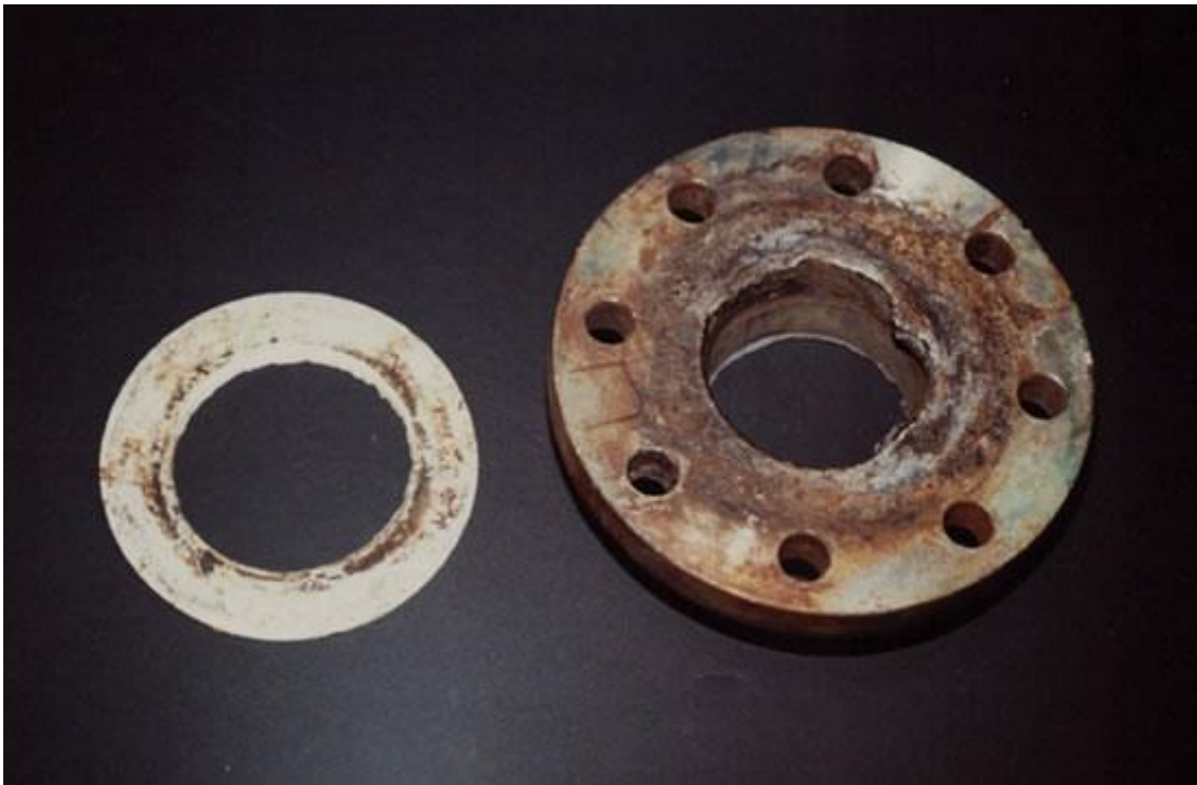
Ilustración 6. Corrosión en Grietas
