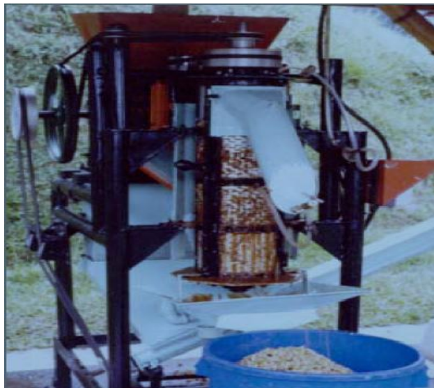
Figura 2. El mucilago de café es obtenido mediante desmucilagadores mecánicos. Fuente Garavito, 1998
