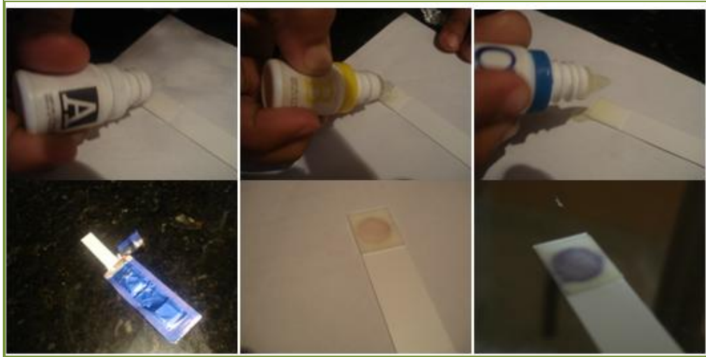
Figura 9. Secuencia del Método para evaluar la limpieza de una superficie.
