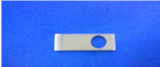
Figura 6. Cupón para ensayo de corrosión.
