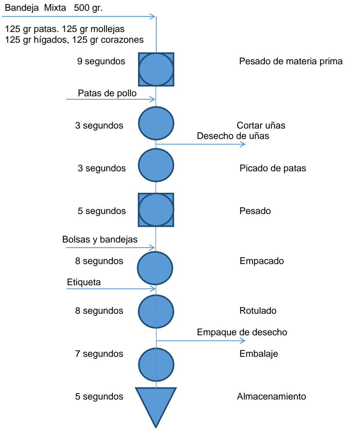
Figura 5. Diagrama de operación de bandeja mixta.
