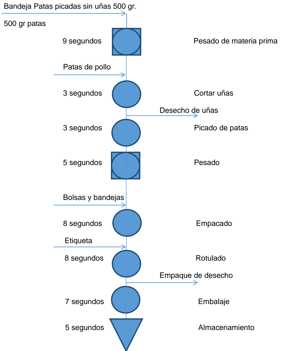
Figura 19. Diagrama de operación de bandeja de patas picadas sin unas.
