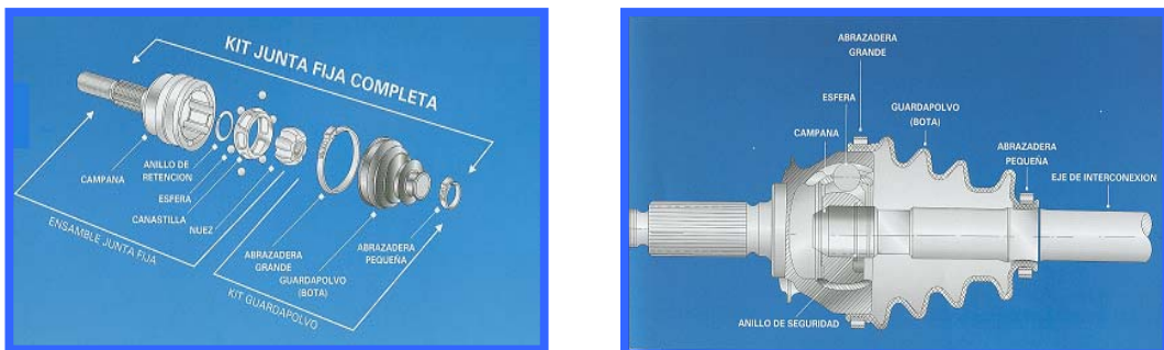
Figura 5. Componentes de la junta fija
