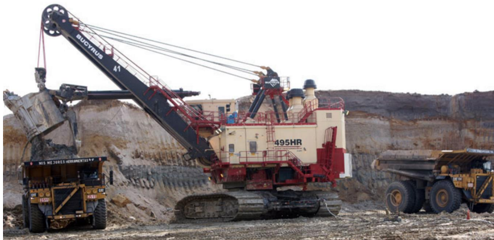
Figura 5. Remoción de capa de material estéril.
