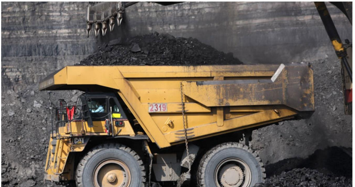
Figura 6. Remoción del Carbón con Palas o Excavadoras.
