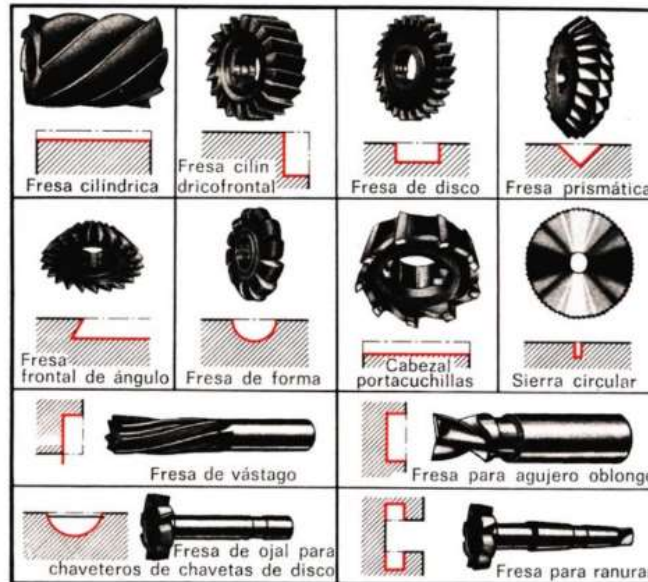
Figura 34. Clasificación de fresas
