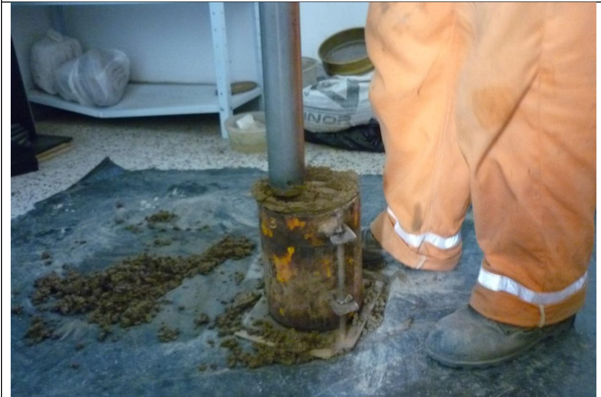
Imagen No 5. Ensayo de Proctor.
