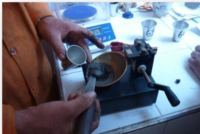
Imagen 26. Tomando la muestra de humedad.
