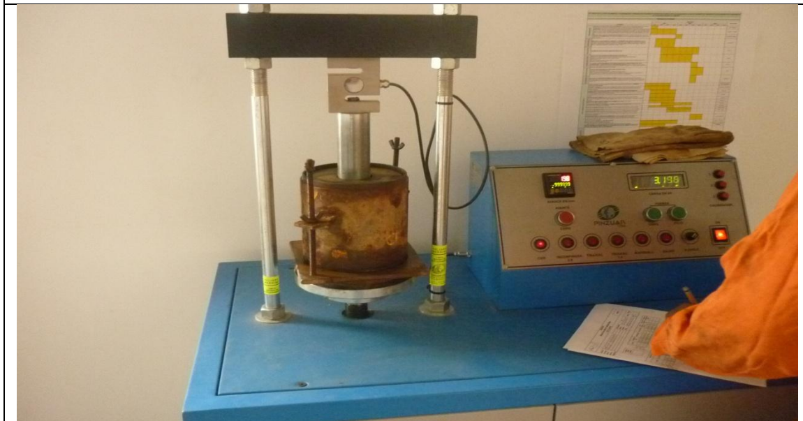
Imagen No 6. Ensayo de CBR
