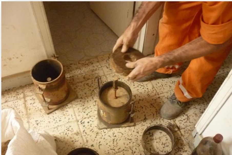
Imagen 34. Colocación de los anillos de carga.
