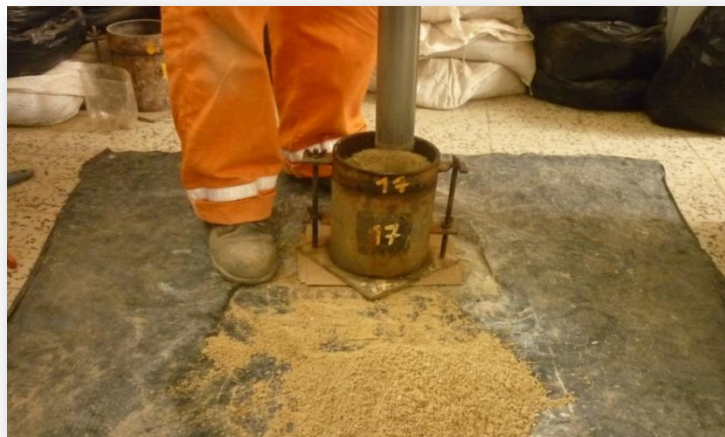
Imagen 9. Ensayo de Proctor Modificado.
