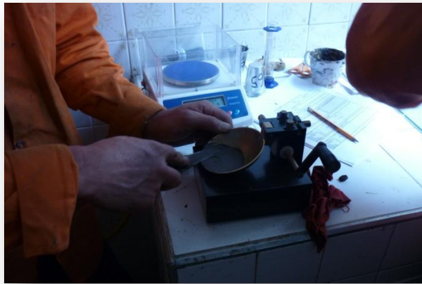
Imagen 23. Extendiendo el material sobre la cazuela.
