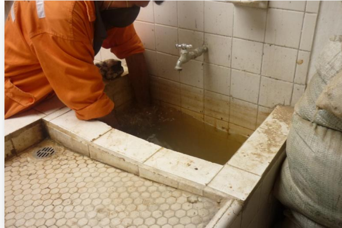
Imagen 11. Las muestras se sumergen en agua durante un periodo de 3 días
