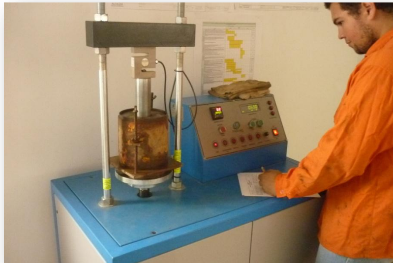
Imagen 12. Realización del ensayo CBR.
