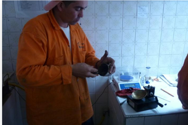
Imagen 22. Preparación de la mezcla para la realización del ensayo de limite liquido.
