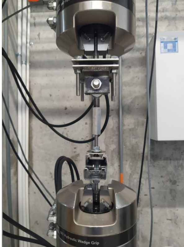
Figura 14. Máquina de ensayos universal con el banco de pruebas de carga normal.
