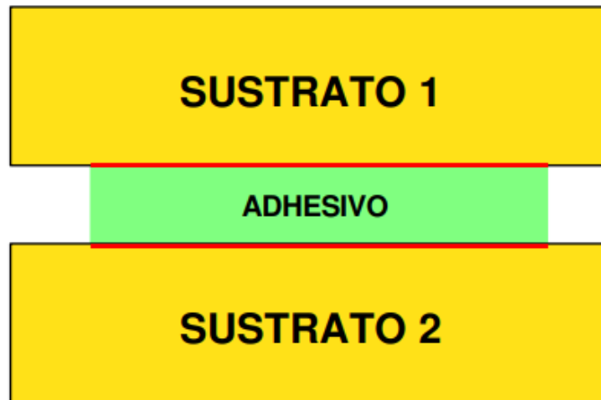
Figura 2. Esquema de una unión adhesiva
