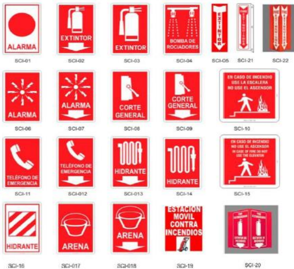
Ilustración 5. Señales relativas a los equipos de lucha contra incendios.
