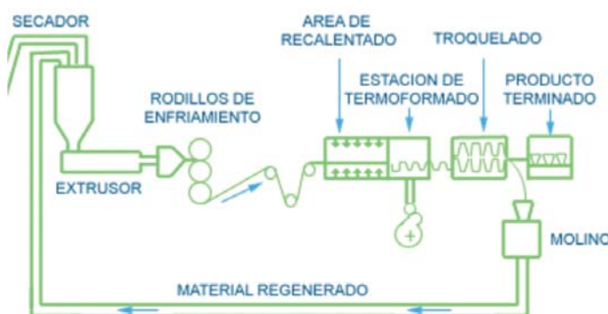
FIG. 8 LINEA DE TERMOFORMADO INTEGRADA PARA ENVASES DE PET
