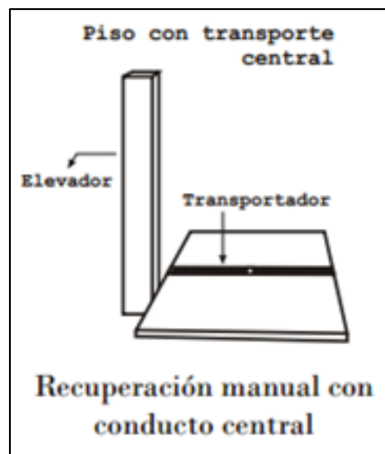
Figura 29. Piso con sistema recuperador de transporte central.
