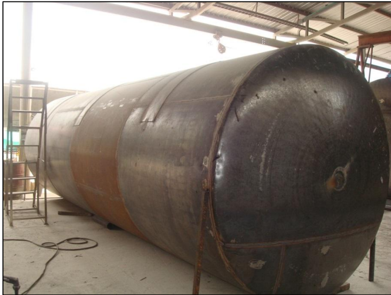
Figura 17. Fabricación de un tanque para transporte de combustible. Acero con signos de corrosión.
