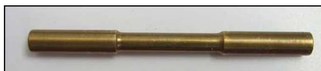
Fotografía 14. Probeta utilizada para los ensayos de tracción.
