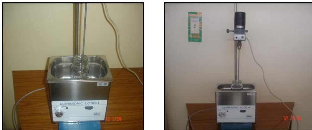
Figura 18. Montaje de la dispersión usando ultrasonido con agitación mecánica.
