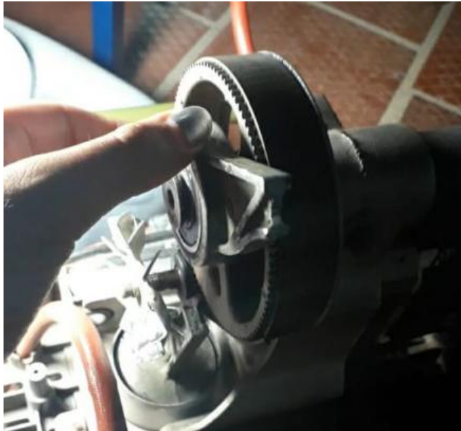
Fotografía 6. Manivela del pistón fracturada
