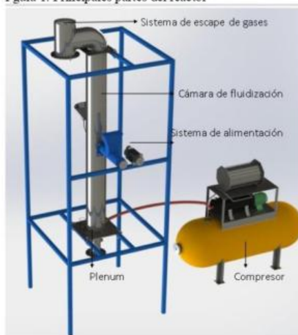
Figura 1. Principales partes del reactor
