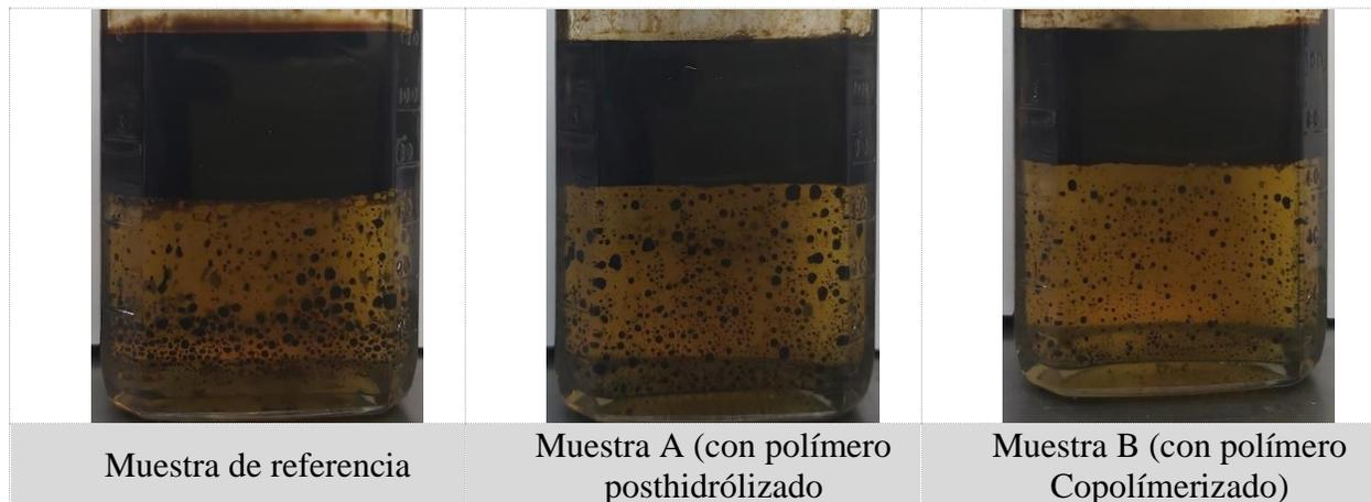
Figura 26. Registro fotográfico tendencia emulsionante de fase oleica en presencia de inhibidor de corrosión.
