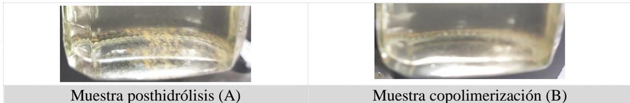
Figura 28. *Precipitados formados en fases acuosas influenciadas por polímeros en presencia de inhibidor de Scale.*
