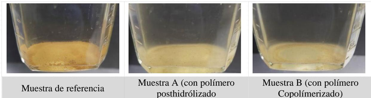
Figura 16. Registro fotográfico precipitación sólidos por interacción fase acuosa con y sin influencia de HPAM.
