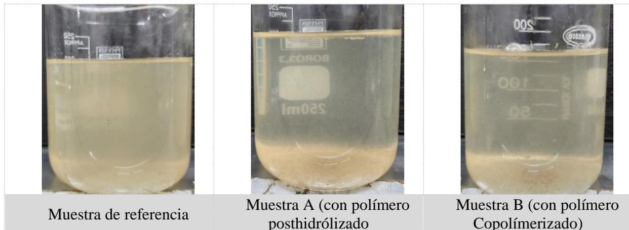
Figura 35. Registro fotográfico proceso de coagulación.
