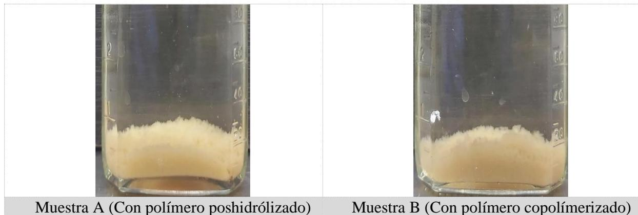
Figura 37. Registro fotográfico proceso de clarificación sin floculante.
