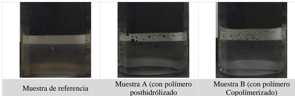
Figura 29. Registro fotográfico tendencia emulsionante fase oleica en presencia de inhibidor de Scale.
