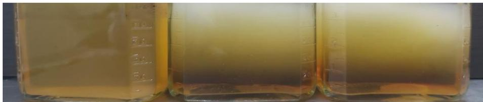
Figura 22. Registro fotográfico compatibilidad entre el inhibidor de corrosión y fases acuosas sin agitación.
