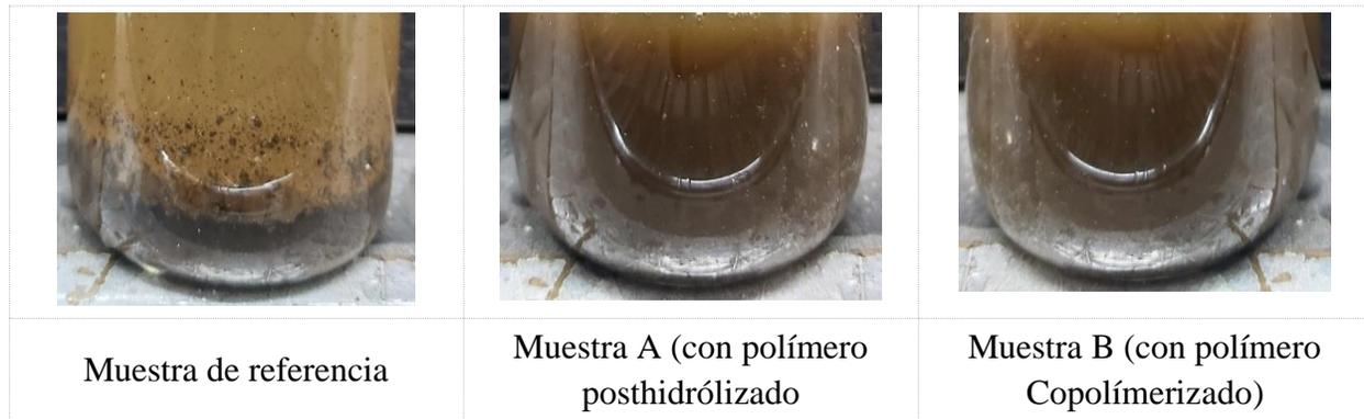
Figura 21. *Comportamiento de la mojabilidad de los sólidos en la fase oleica.*
