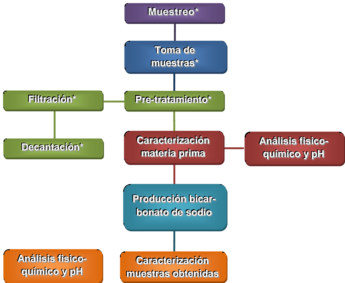
Figura 2. Metodología para la obtención de bicarbonato de sodio a partir de agua de producción y salmuera sintética (* etapas realizadas únicamente para agua de producción)
