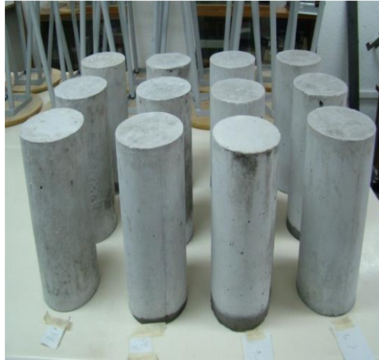
Figura 8. Probetas del concreto posterior al curado en el Laboratorio de Caracterización de materiales.
