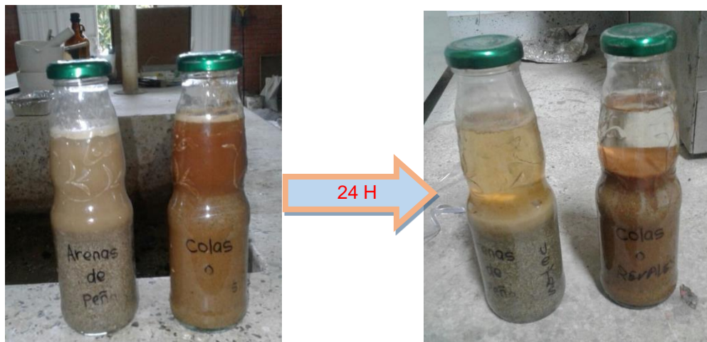
Figura 7. Ensayo de prueba de impurezas orgánicas. Mezclas agitadas y con 24 horas de reposo respectivamente.
