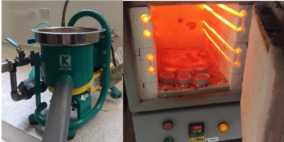
Figura 3. Concentrador Knelson KC-MD3 y mufla Terrigeno usados para la concentración y ensayos al fuego respectivamente.
