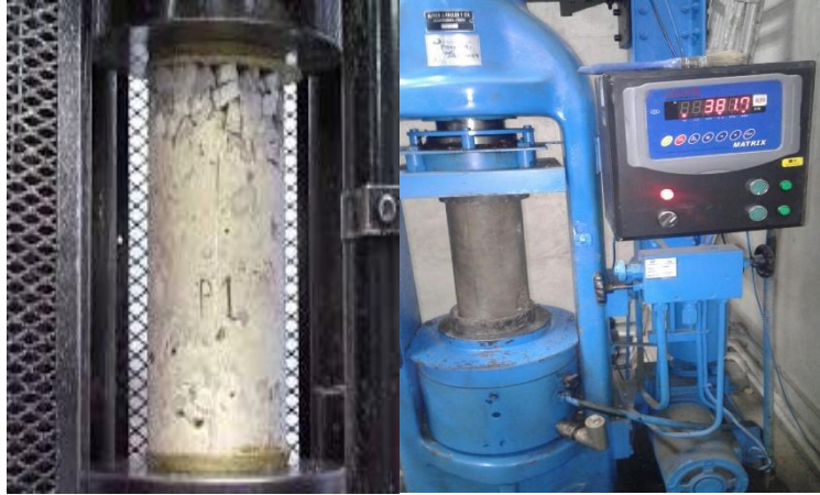
Figura 9. Ensayo de resistencia a la compresión a probetas de concreto preparado con el componente relaves del proceso gravimétrico de Reina de Oro
