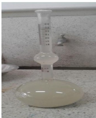
Figura 4. Ensayo para determinar de la densidad real en la botella Le Chatelier
