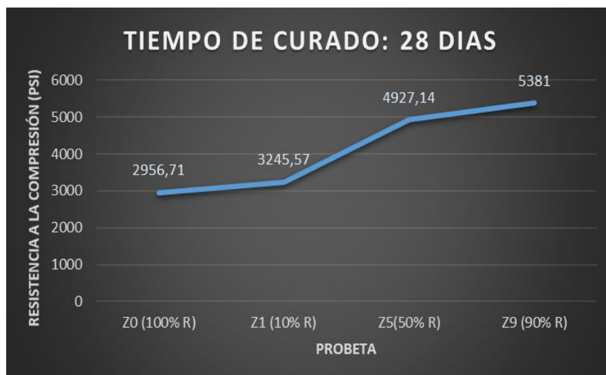
Figura 10. Resistencia a la compresión de las probetas de concreto tipo D a los 28 días de curado.
