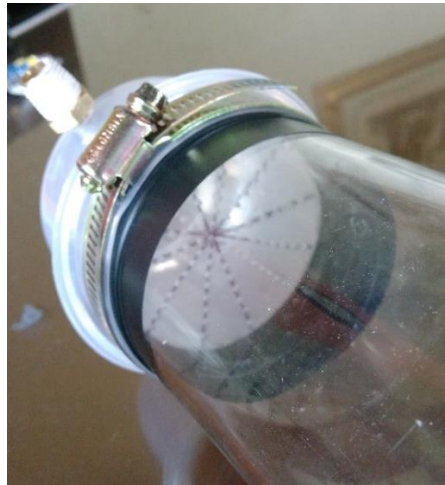
Figura 37. Detalle de las juntas en la cámara de presión.
