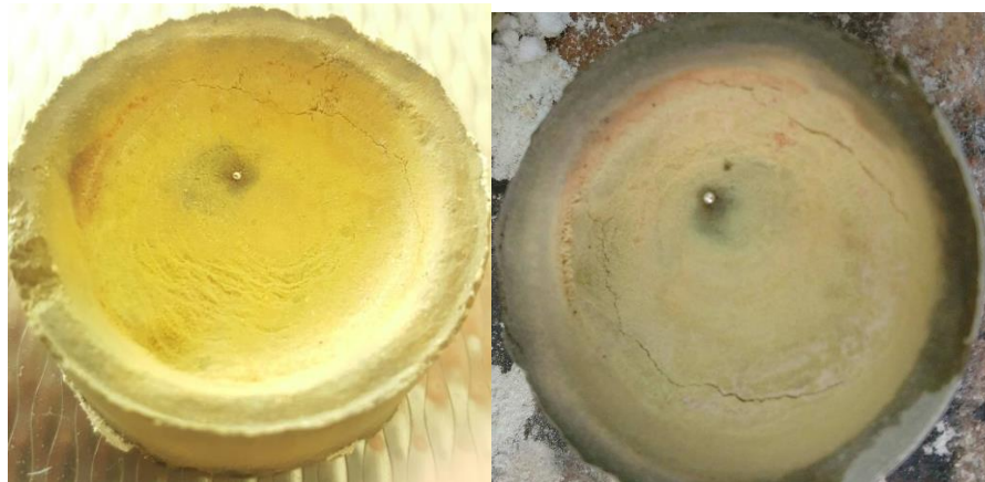
Figura 50. Comparación en el tamaño del dore antes y después de concentrar.
