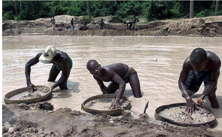
Figura 3. Extracción de oro con batea.
