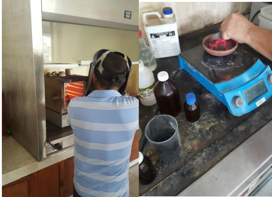
Figura 13. Tostación y oxigenación de la muestra según la ASTM E-400-2
