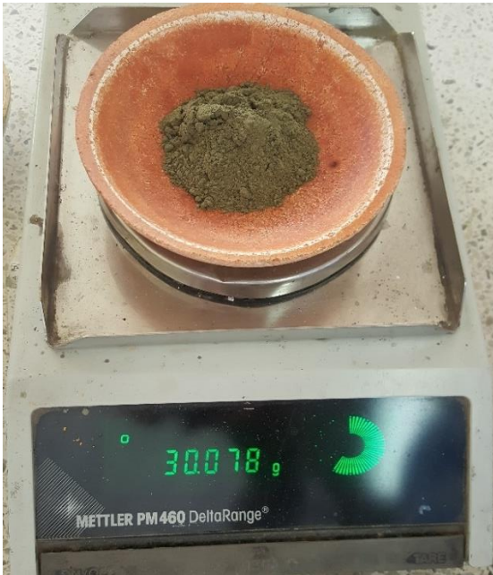
Figura 12. Preparación de 30 g de mineral para el ensayo al fuego.
