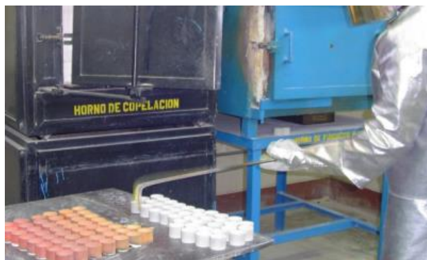
Figura 59. Carga y descarga de copelas en el horno.
