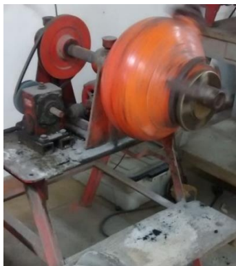
Figura 11. Molino de bolas con los residuos del sílex usado para su limpieza.
