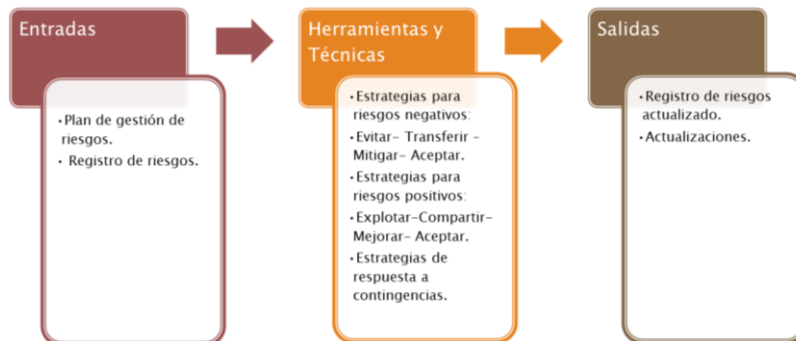
Ilustración 21. Planificar la Respuesta a Riesgos
