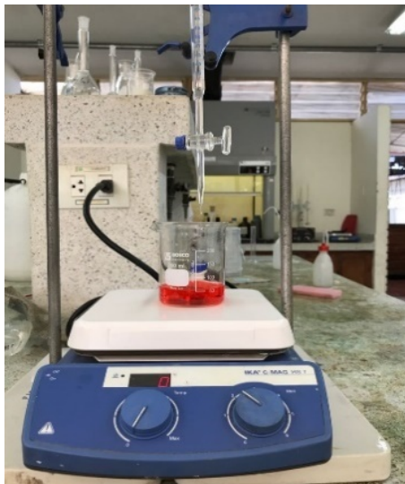
Figura B.1. Montaje experimental titulación ácido clorhídrico comercial
