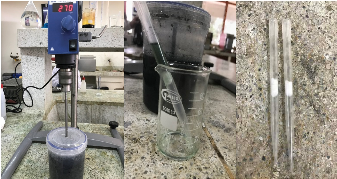
Figura C.1. Montaje experimental de las lixiviaciones y filtros para muestras
