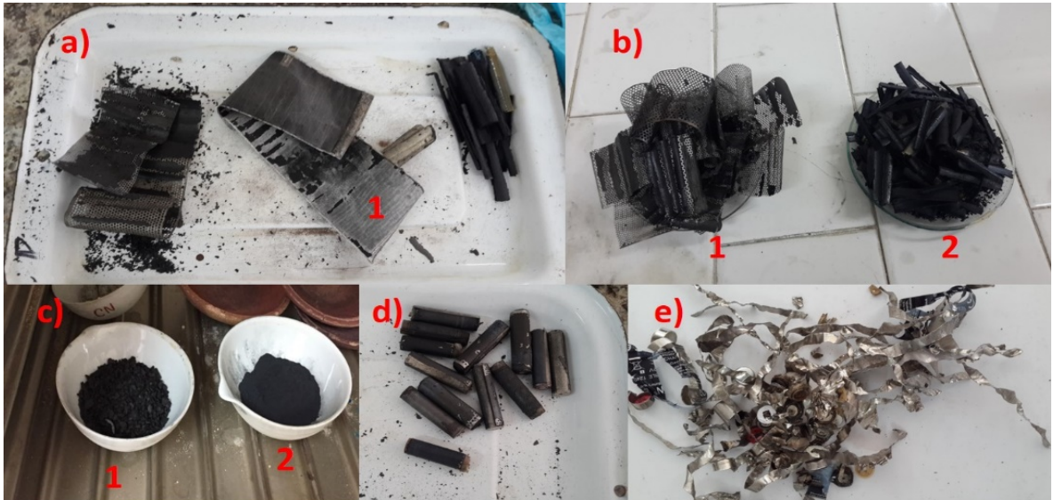
Figura A.2. Componentes baterías Ni-MH, a.1) Papel separador, b.1) Malla anódica, b.2) Polvo electrodico mezclado, c.1) Material catódico, c.2) Material anódico, d) Baterías sin carcasa, e) Carcaza metálica
